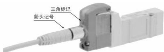
注) 安装电缆插头是有方向性的。使用本公司的插头电缆 (V100-49-1-□) 时，请将插头部的箭头记号对准电磁阀侧的三角记号。请注意若不顾方向性强行拧入，会造成插针的破损等故障。
