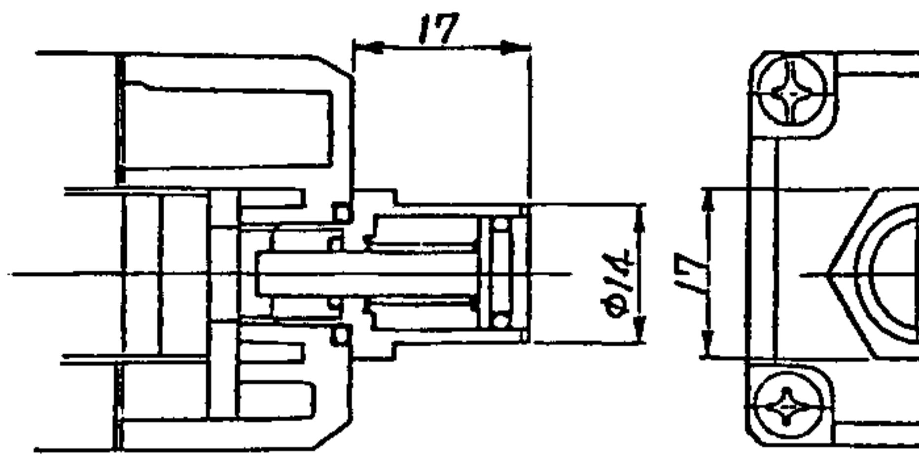
拿开电磁头上的胶塞，然後装上推压按钮。推压按钮直至阀门转位，然後转动顺时针方向  $90^\circ$ ，保持在锁定位置；相反方向转动  $90^\circ$ ，则可松锁。确认以电源操作电磁阀前按钮是在松锁位置。
