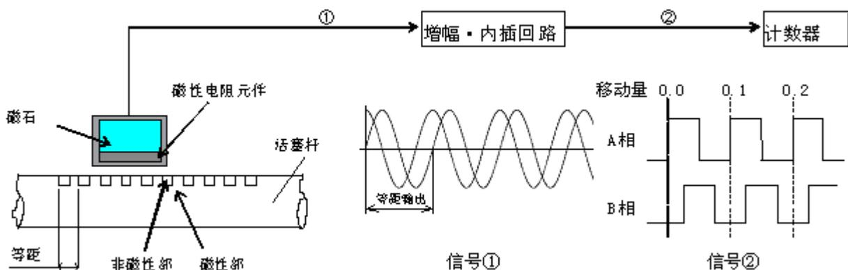
① 活塞杆表面每隔一定距离排列着磁性部分和非磁性部分的刻度。
