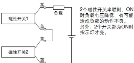
2个磁性开关串联时，ON时负载电压降低，有可能造成负载的动作不良。另外，2个开关都为ON时指示灯才亮。
